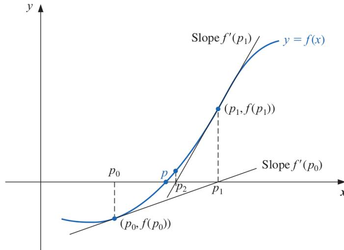
Sea  $\{x_n\}_n$  una iteración de Newton. Dado  $x_n$ , definimos  $x_{n+1}$  como la abscisa de la intersección entre la recta tangente a  $f$  en  $x_n$  y el eje  $x$ . La recta tangente a  $f$  en  $x_n$  es  $y = f'(x_n)x + b$  siendo  $b$  la ordenada al origen. Para  $x = x_n$ , esta recta toma el valor  $y = f(x_n)$ , con lo cual  $f(x_n) = f'(x_n)x_n + b$ , i. e.,  $b = f(x_n) - x_n f'(x_n)$ . Luego, la recta tangente a  $f$  en  $x_n$  es
