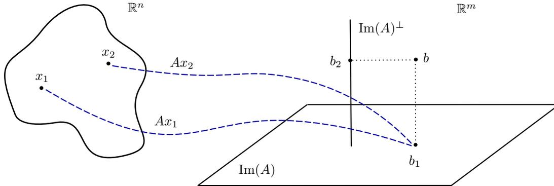
En la figura,  $b_1 = \text{proy}_{\text{Im}(A)}(b)$  es el punto que realiza la distancia,  $b_2 = \text{proy}_{\text{Im}(A)^\perp}(b)$ , y  $x_1$  y  $x_2$  son soluciones.
