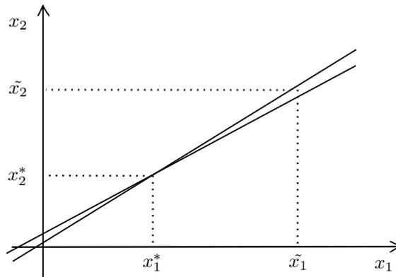
Este sistema tiene solución única  $x^* = \begin{pmatrix} x_1^* \\ x_2^* \end{pmatrix}$ . Al resolverlo numéricamente encontramos una aproximación de la solución dada por  $\tilde{x} = \begin{pmatrix} \tilde{x}_1 \\ \tilde{x}_2 \end{pmatrix}$  que, debido a la proximidad entre rectas, es tal que  $A\tilde{x} = \tilde{b}$  con  $\tilde{b}$  parecido a  $b$ . Sin embargo, pese a este parecido,  $\tilde{x}$  está muy lejos de la solución exacta  $x^*$ .
